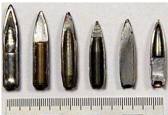
Рис. 10. Некоторые конструкции пуль: модернизированная пуля БЗТ, трассирующая пуля Т-46, бронебойно-зажигательная пуля Б-32, пуля ЛПС, тяжелая пуля Д, снайперская пуля ПС
