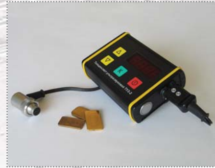
Ультразвуковой детектор / выявление высококачественных подделок, в которых слой золота любой толщины покрывает внутренний слой ("начинку") из недрагоценного металла
