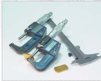
Штангенциркуль, микрометры с электронным измерительным блоком (МК 25 и МК 50 или аналогичные) / определение размеров слитков, расчет условной удельной плотности
